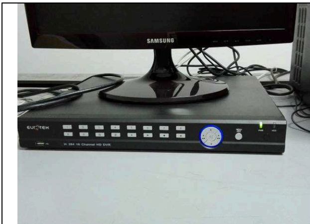
Fronte DVR dell'impianto di videosorveglianza
